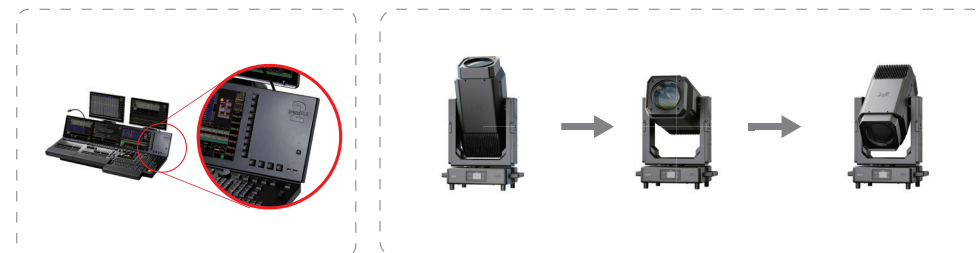
灯具断电前先切断控台信号 (关控台电源或手动断开信号)
